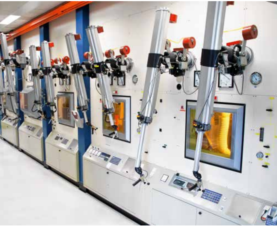
Abb. 4: Produktion von Molybdän-Generatoren in einem GMP-Labor mit entsprechenden Strahlenschutzvorrichtungen (Quelle: C. Töllner, Curium Pharma)
