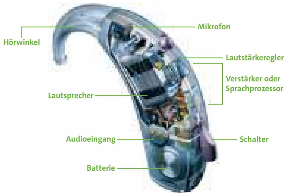
Das Mikrofon hat die Aufgabe, den Schall aufzunehmen. Sprache, Musik, Geräusche und alle anderen Schallereignisse werden im Mikrofon in elektrische Schwingungen umgewandelt, die dann im Verstärkerteil oder Sprachprozessor verstärkt und aufbereitet werden.
